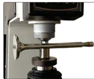
压头罩(选配), 适用于长工件, 在测试过程中固定工件
