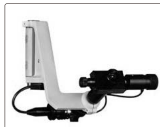
布氏、维氏测量系统(符合ISO 6506-6507/ASTM E10-E384标准)(选配), 具有光学与压痕轴自动对准的旋转臂, 含维氏、努氏和布氏压痕读数软件, 能进行冶金分析
