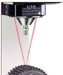
激光指示系统(选配), 在压头和工件接触之前, 可以精确地指向测试位置, 适用于齿轮、切削工具的边缘
